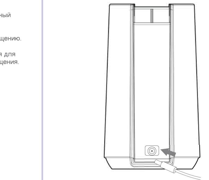
\* Подключите адаптер к порту зарядки, который расположен в задней части корпуса лампы.
