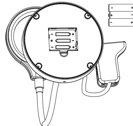
Снимите крышку отсека для батареек, вставьте 3 батарейки типа АА в соответствии с указанной полярностью и закройте отсек для батареек.
