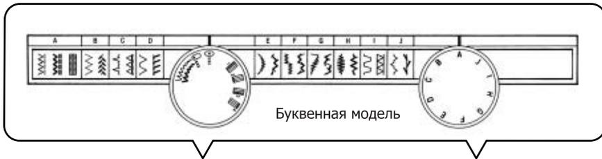
При помощи регулятора ширины зигзага можно выбрать ширину зигзагообразной строчки ( и ), положение иглы (центральное и левое) для прямой строчки и тройной строчки ( и ), а также режим пришивания пуговиц.
