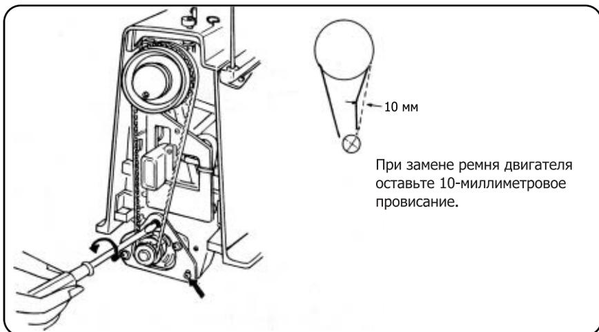
Чтобы отрегулировать натяжение ремня, снимите крышку и ослабьте крепежные винты, сделав приблизительно один поворот отверткой. Это даст возможность мотору двигаться вверх или вниз. Плотнo закрутите винт, в результате этих действий образуется необходимое натяжение ремня.
